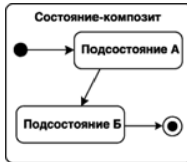
Рисунок 7 – Графическое представление составного состояния с двумя вложенными в него последовательными подсостояниями
