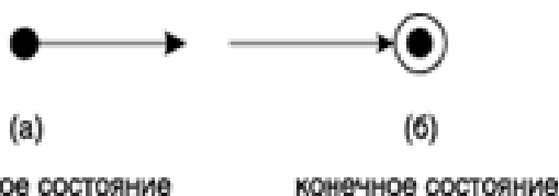
Рисунок 3 – Графическое изображение начального и конечного состояний
