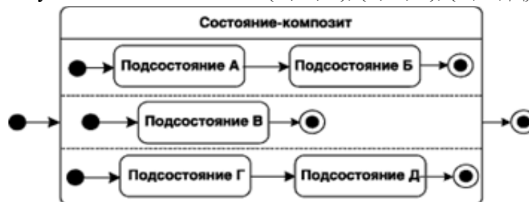
Рисунок 9 – Графическое изображение состояния-композиита с вложенными параллельными подсостояниями
