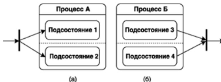
Рисунок 11 – Графическое изображение перехода-разделения в параллельные подсостояния (а) и перехода-слияния из параллельных подсостояний (б)
