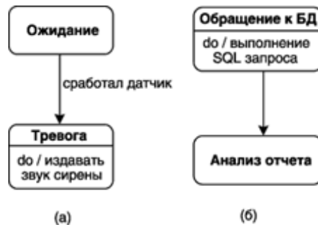
Рисунок 4 – Графическое изображение триггерного (а) и нетриггерного (б) переходов на диаграмме состояний
