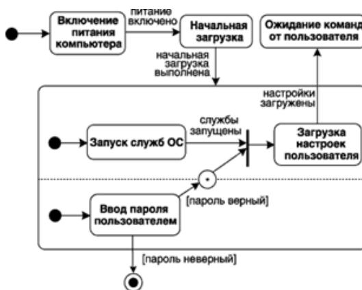
Рисунок 12 – Диаграмма состояний для примера включения компьютера
