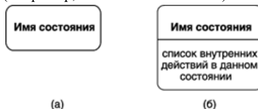
Рисунок 1 – Графическое изображение состояний на диаграмме состояний
